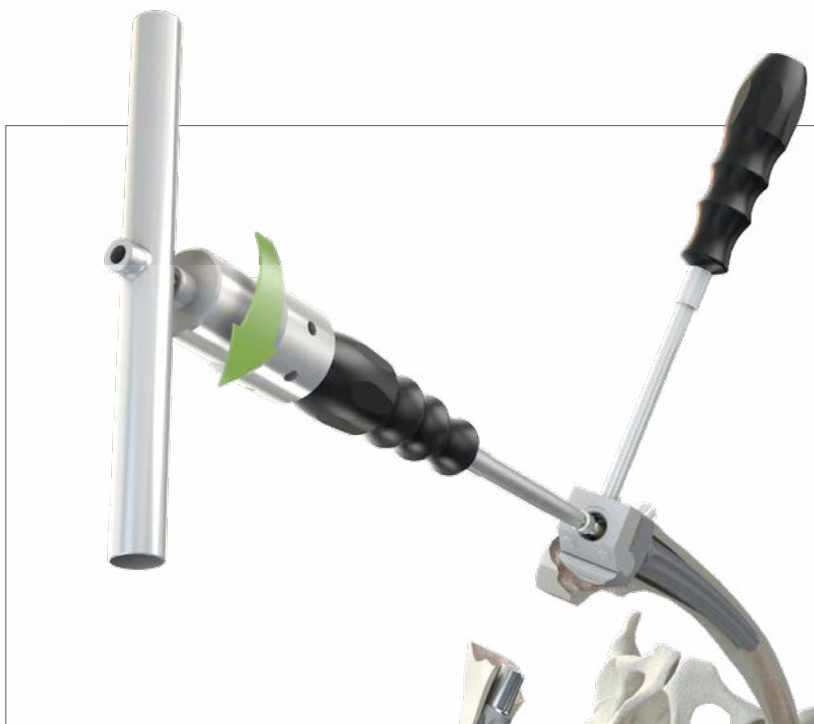
KAM-Schraube M6 mit Drehmomentbegrenzer 25 \pm 1 Nm und Steckknebel SW6 anziehen. Danach werden die Bolzen für Gegenhalter, die den Gegenhalter sichern, entfernt.
