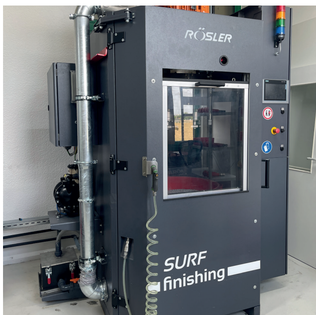
Abbildung 1: Schleppsleifmaschine Fa. Rösler, teilautomatisiert R4/700SF
