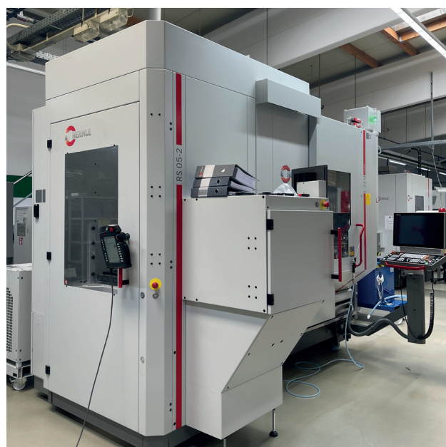
Abbildung 2: CNC Maschine Fa. Hermle C22U mit Automation RS-05
